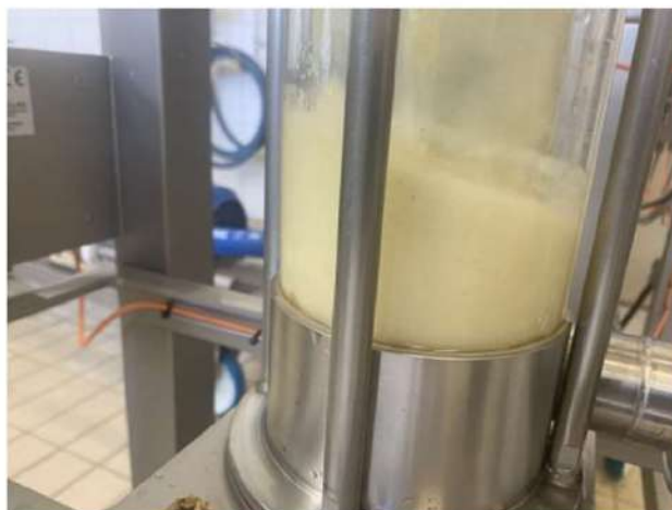
Sungold kiwi sap in de extractiecel van de spiraalfilterpers
