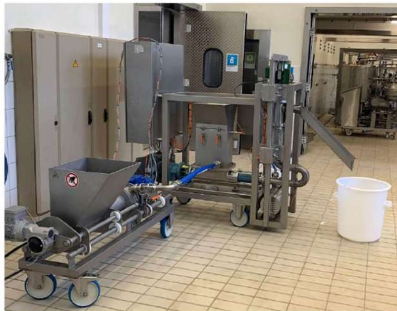
Sungold kiwi sap in de extractiecel van de spiraalfilterpers
